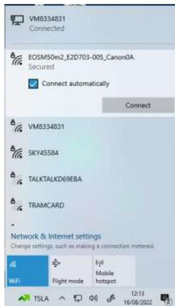
Cuando la PC está conectada a la red WiFi de la cámara, la cámara mostrará automáticamente una **URL de dirección de conexión** para la API de control de cámara...
