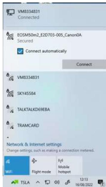
Quando o PC estiver conectado ao WiFi da câmera, a câmera exibirá automaticamente uma **URL de endereço de conexão** para a API de controle da câmera...
